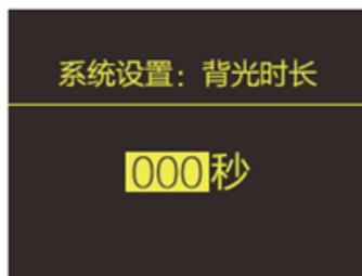
背光时长：设置背光灯点亮时间长度，0 为关闭背光灯，中控板将停止显示信息，节约电量。默认背光时长为 xx 秒
