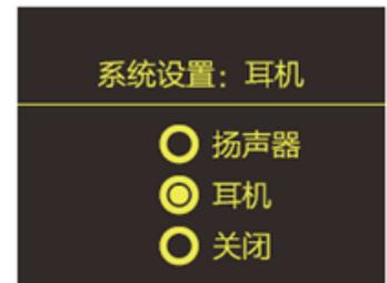
耳机设置: 插上耳机就使用耳机输出声音报警, 不插耳机就用扬
