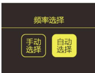
**频率选择：**对设备的发射频率进行选择，包括手动选择和自动选择两种模式
