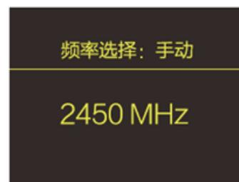
**手动选择：**操作人员通过中控上下按键进行频率输入，上下键步进 1MHz，左右键步进 5MHz
