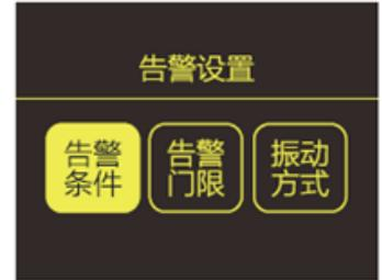
告警设置: 设置设备检测到非线性节点后的报警方式, 包括告警条件、告警门限和振动方式
